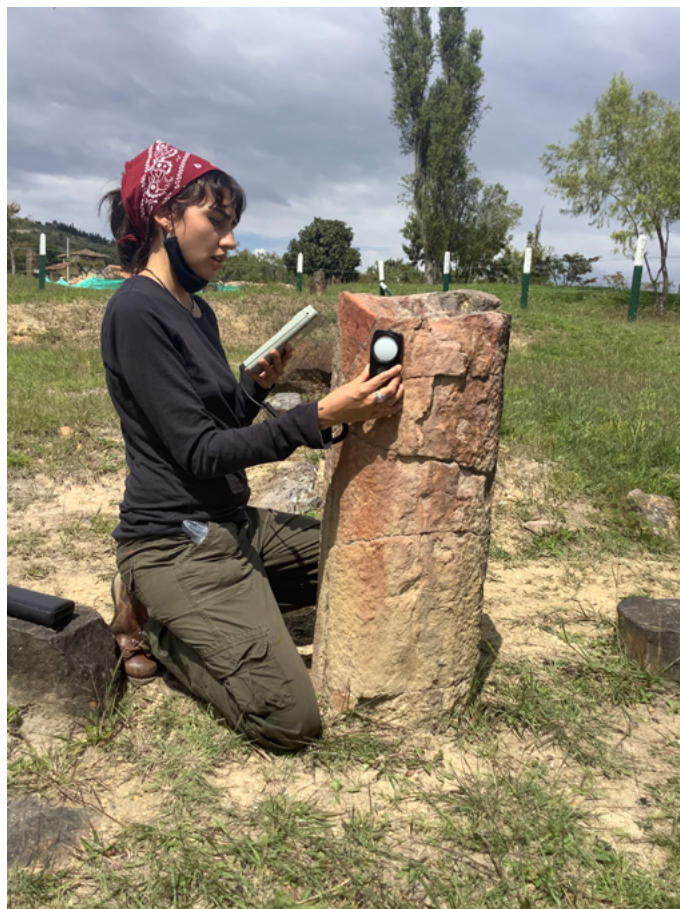
Figura 7. Registro de medición de luz en superficie en monolito V0032 con luxómetro Fuente: elaboración propia.
