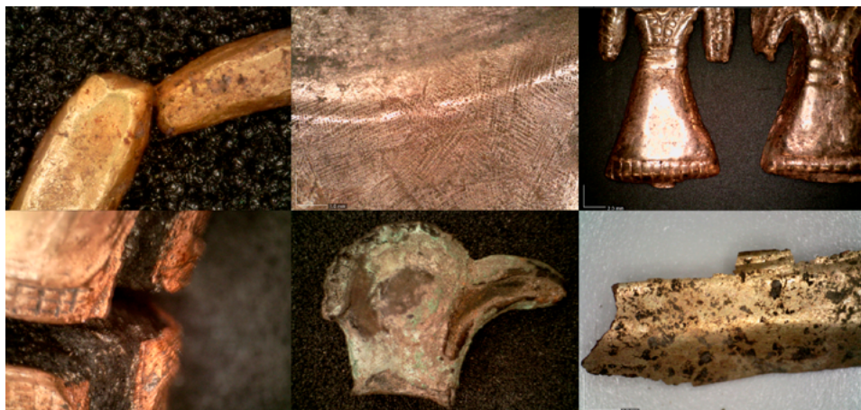
Figura 14. De izquierda a derecha. Arriba: ejemplo de objeto martillado (CA230956), nariguera vaciada a la cera perdida con dendritas y repujado (CA230609) y cuentas de collar vaciadas a la cera perdida con matrices de piedra; nótese las pestañas (CA230986). Abajo: vaciado con núcleo aún dentro (CA230942), vaciado completo (CA231000) y dorado por oxidación (CA220459)
