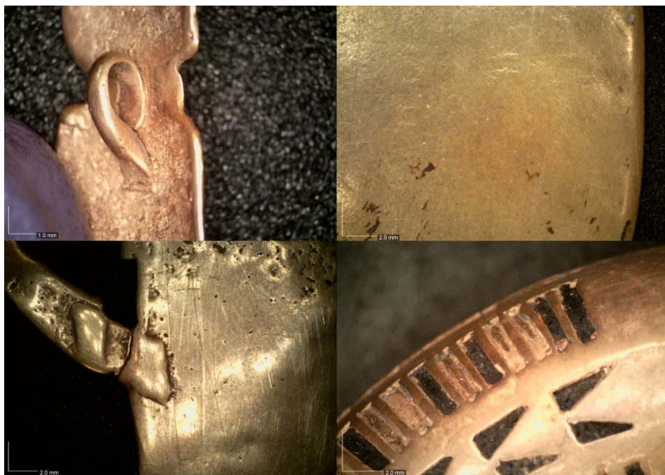
Figura 16. Cuenta de collar con engarce vaciado a la cera perdida (CA230593); nariguera con pulido superficial (CA231019); huellas de unión entre dos piezas de cera, ahora en metal (CA230971); defectos de vaciado en la decoración de nariguera (CA230942)
