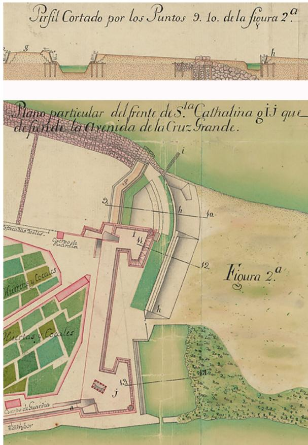
**Figura 11.** Detalles del plano que contiene la planta y sección del espigón construido junto al baluarte de Santa Catalina
